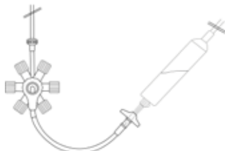
Abb. 1. Entlüftung der Tropfkammer
